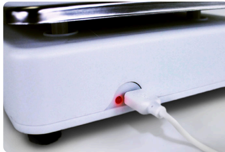
Fonctionne avec une entrée USB à faible tension pour une flexibilité supérieure pour alimenter l'instrument
