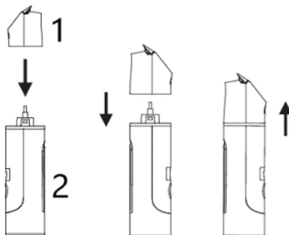
Appuyez sur le bouchon pour ouvrir le bac à poussière et vider les poils
