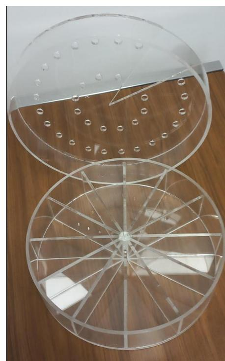
Mouse Pie Restrainer - Dispositif de retenue en acrylique assemblé pour l'irradiation corporelle totale des souris de laboratoire
