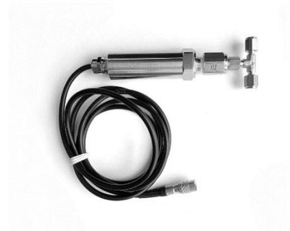
Le capteur de pression se branchera sur la pompe et un connecteur à 3 voies connectera la seringue et le capteur de pression. La pression maximale est de 2000 PSI. Le contrôle de la pression arrêtera la pompe une fois la pression cible atteinte.
